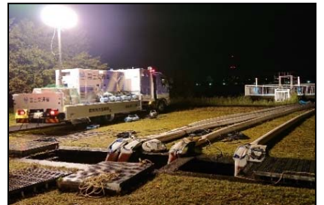
自治体要請による排水ポンプ車の派遣状況
